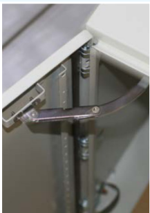
Ограничитель Предотвращает случайное закрывание открытой дверцы; применимо для суровых условий эксплуатации, например, на открытом воздухе, на судах
