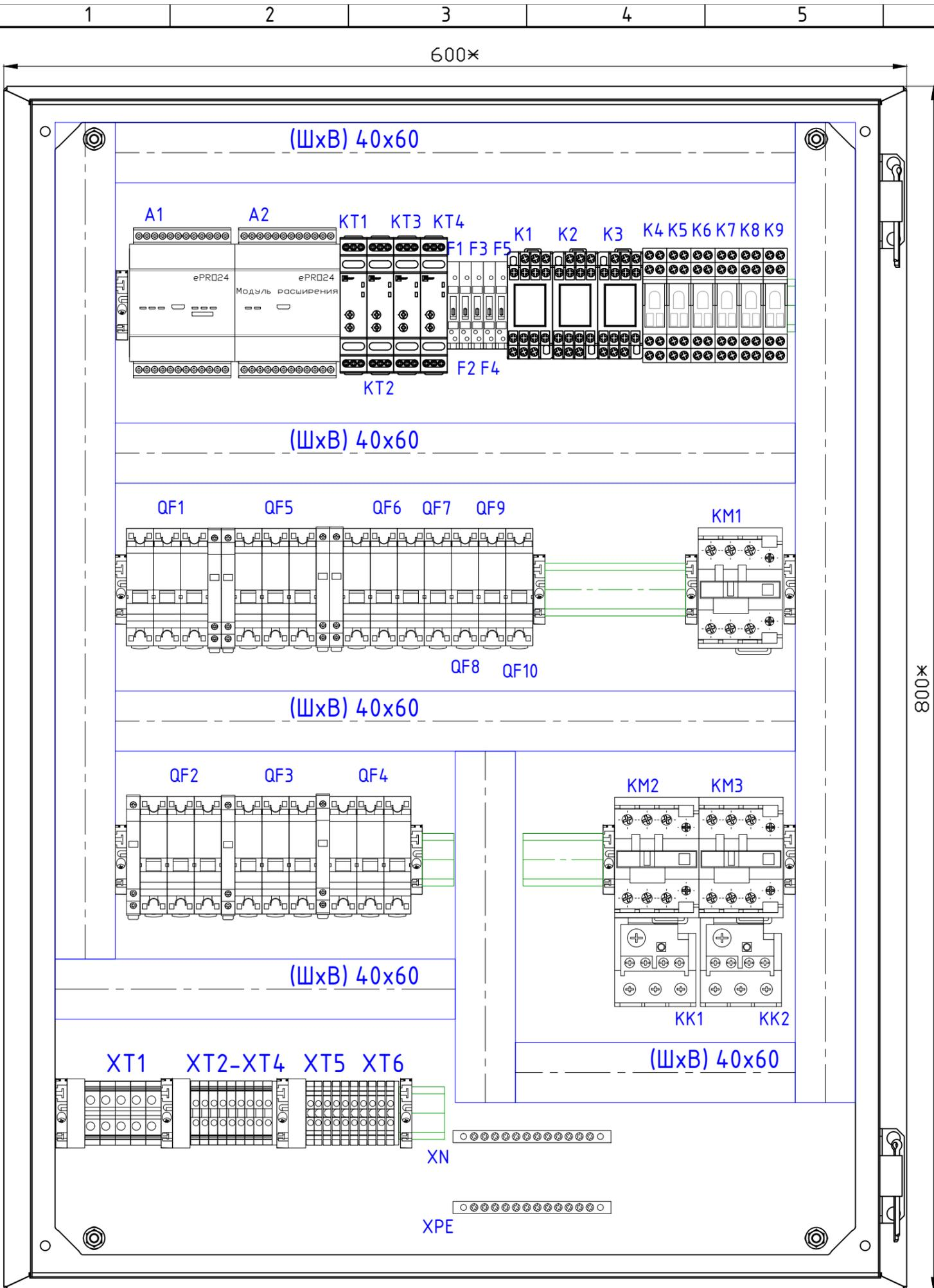
Шкаф управления : 3 линии зарядных устройств, 2 вентилятора, ePRO24, схема ШУЗС3Л2В v1, исполнение в ЩМПГ IP54.
