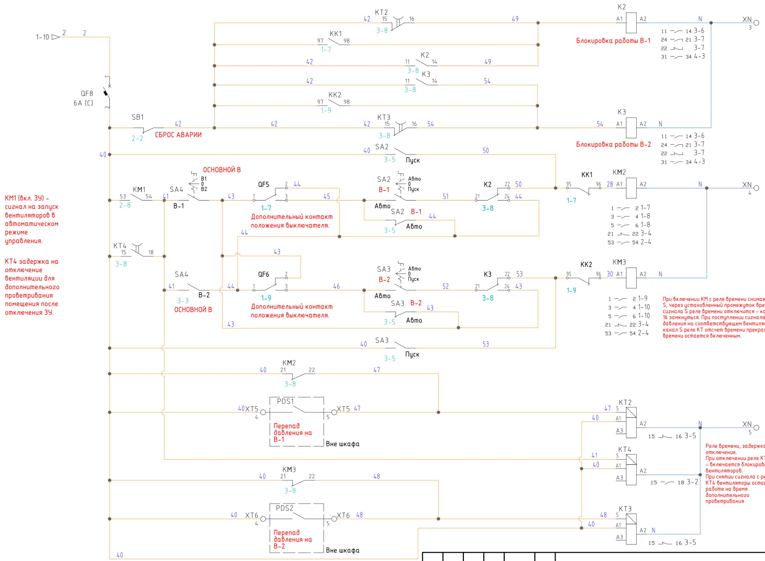
КМ1 (вкл. ЗУ) – сигнал на запуск вентиляторов в автоматическом режиме управления.
