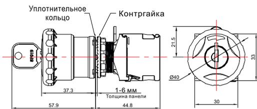
Диаметр головки 40 мм
