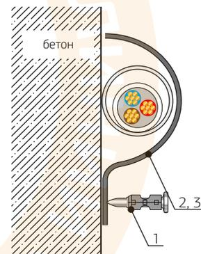
\* При использовании СМД применяется доп. гвоздь по бетону
