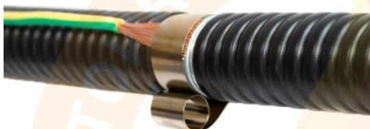
Прижать провод заземления одним витком пружины так, чтобы нижний край пружины находился на расстоянии не более 5 мм от среза изоляции.
