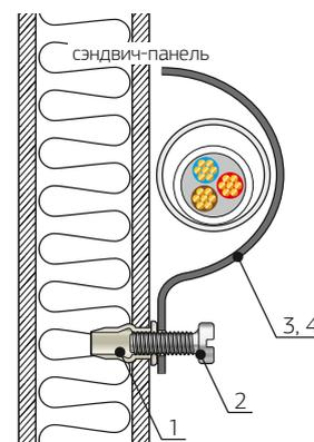
\* При использовании СМД применяется доп. заклепка и винт
