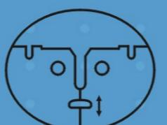
4 регулируемых гнезда под крепежные винты для установки
