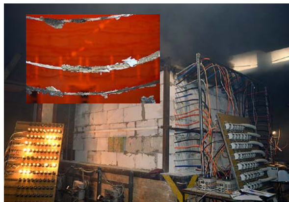
Рис. 1. Внешний вид испытательной печи и контрольно-измерительного оборудования во время испытания.
