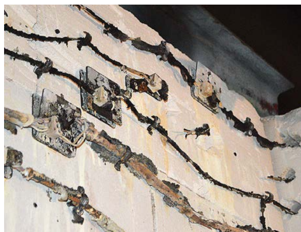
Рис. 2. Кабельные линии до и после испытания.
