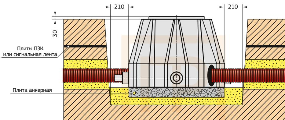
Рисунок №19. Установка вне проезжей части
