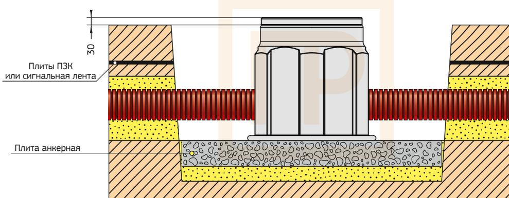
Рисунок №15. Установка вне проезжей части
