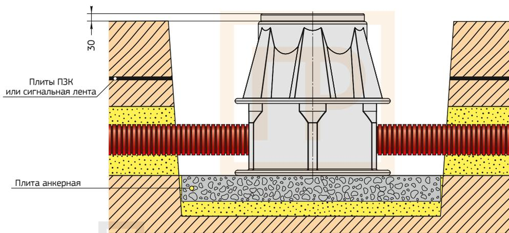
Рисунок №17. Установка вне проезжей части
