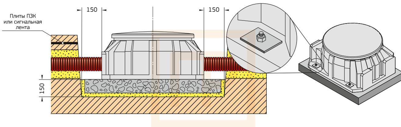
Рисунок №25. Установка вне проезжей части
