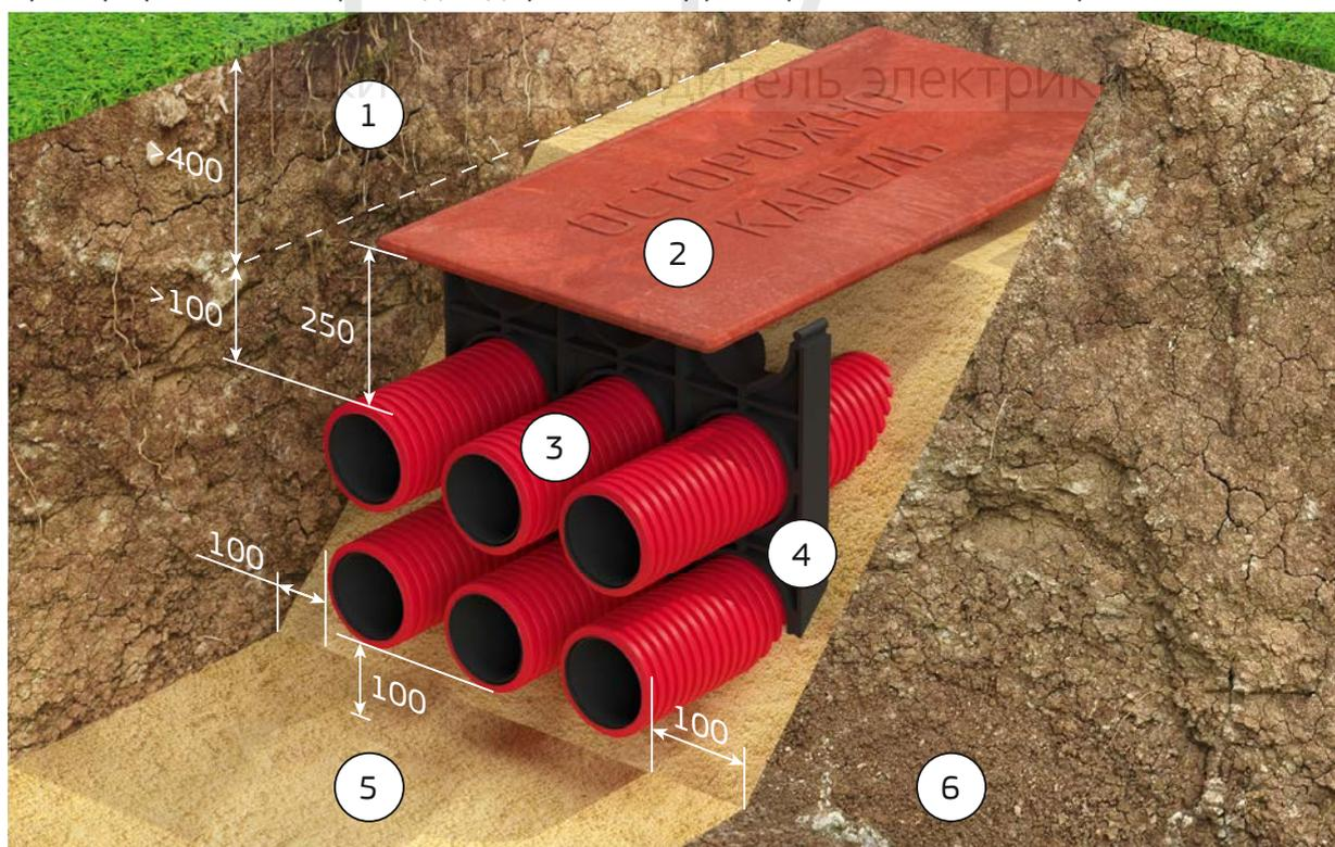
1 — траншея; 2 — плиты ПЭК или сигнальная лента; 3 — труба двустенная; 4 — кластер; 5 — засыпка; 6 — грунт.
