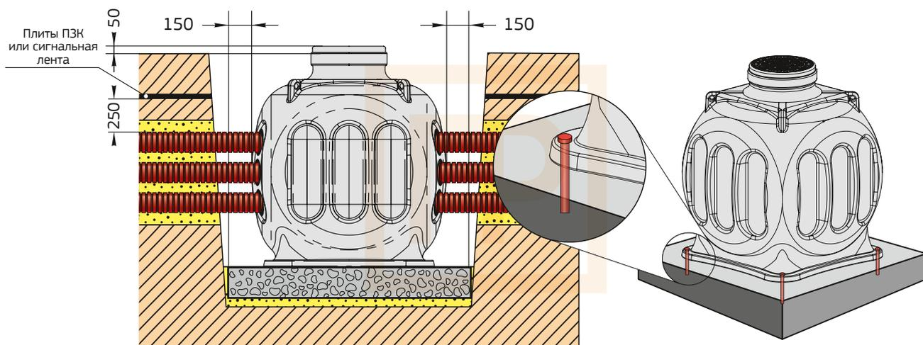
Рисунок №23. Установка вне проезжей части
