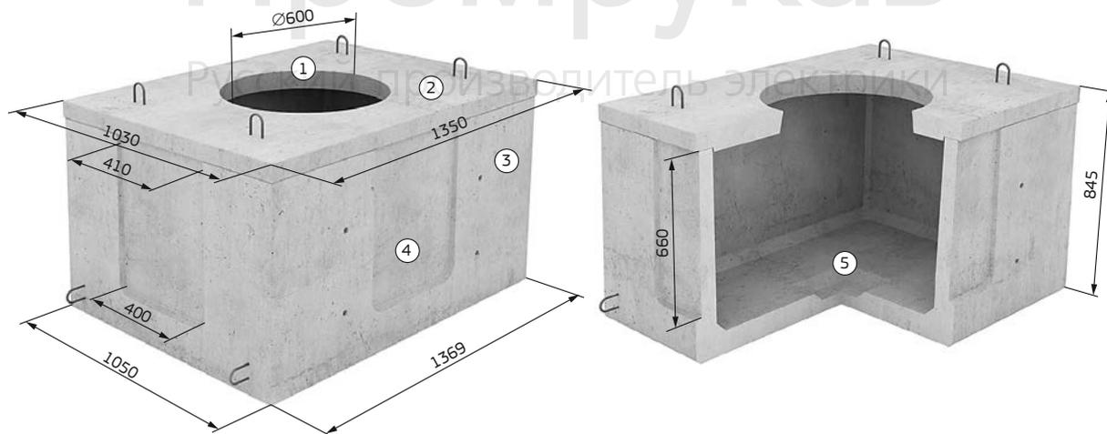
Рисунок №7. Внешний вид и детали элементов колодца «ККСр-1-10(80)»:
