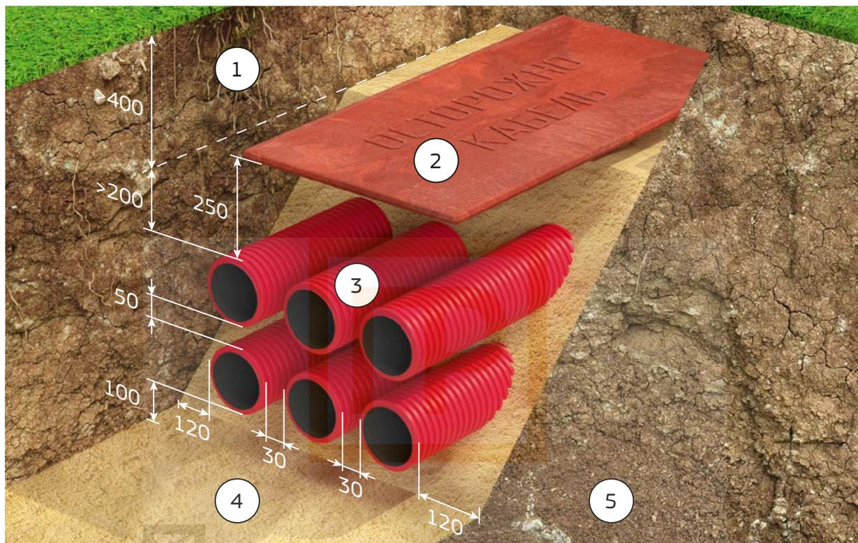
1 — траншея; 2 — плиты ПЭК или сигнальная лента; 3 — труба двустенная; 4 — засыпка; 5 — грунт.
