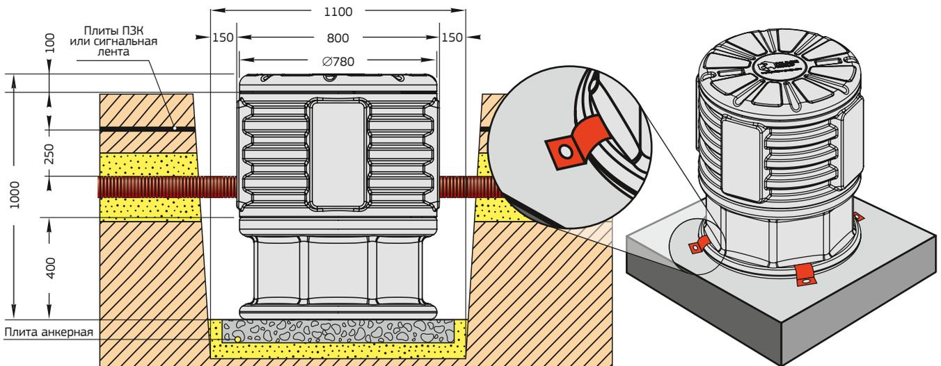
Рисунок №22. Установка вне проезжей части
