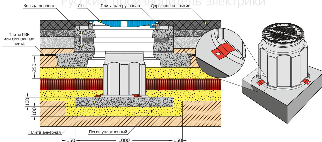
Рисунок №16. Установка под проезжую часть
