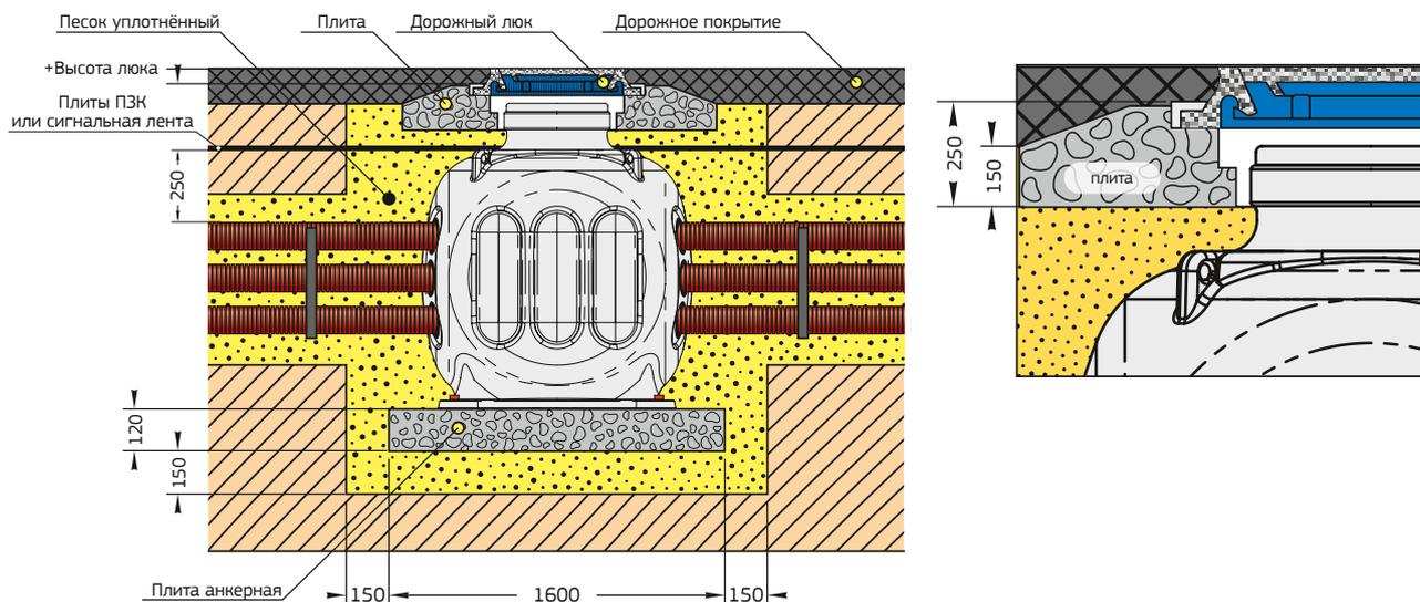
Рисунок №24. Установка под проезжую часть
