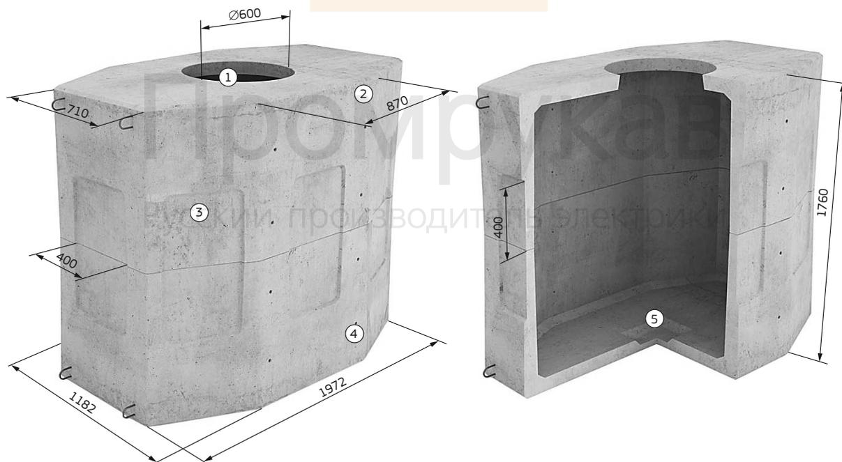
Рисунок №11. Внешний вид и детали элементов колодца «ККСр-3,5-10(80)»:
