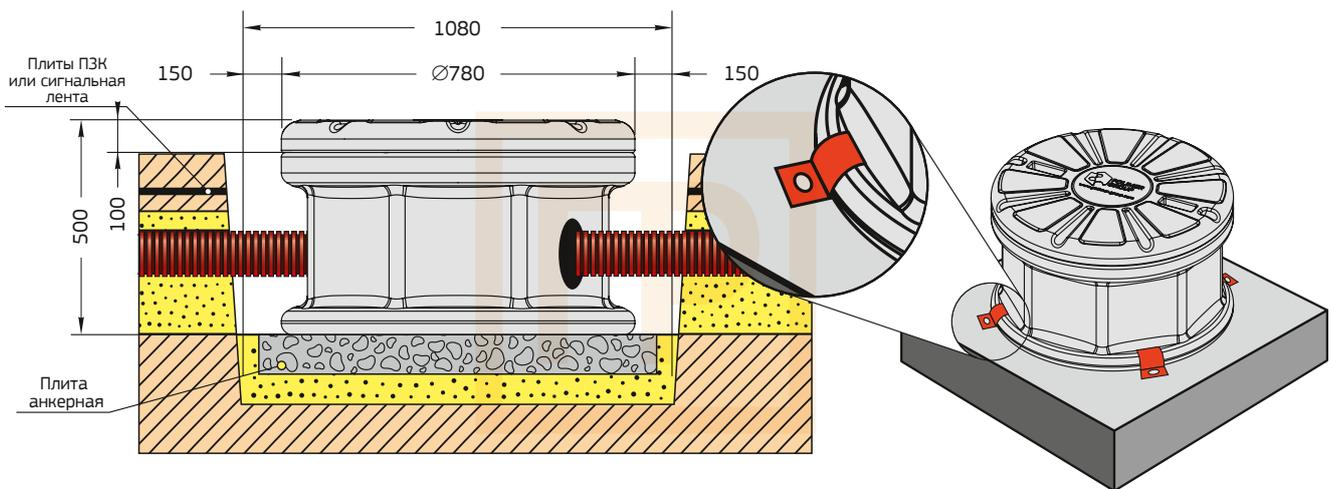
Рисунок №21. Установка вне проезжей части
