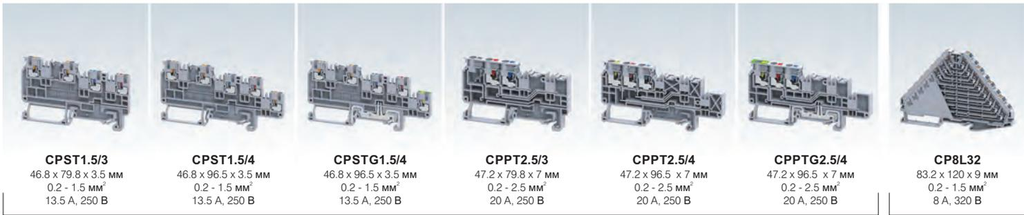
Клеммы Push-In для датчиков и исполнительных устройств серии CP
