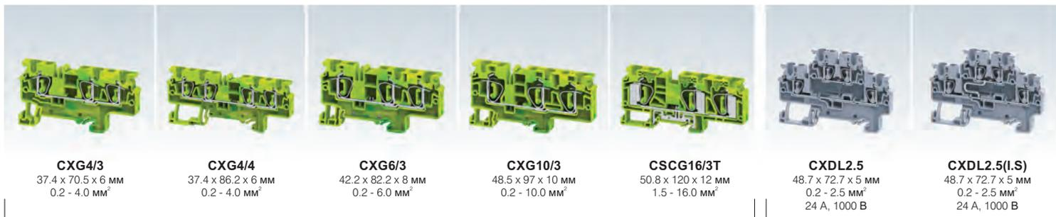
Клеммы заземления пружинные на 3 и 4 присоединения серии CX
