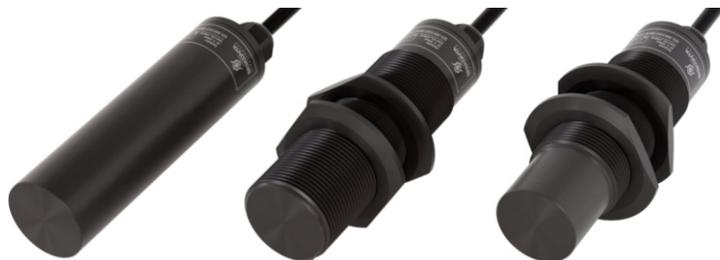
**Емкостный датчик серии «SES»** – электронное устройство, реагирующее на изменение относительной диэлектрической проницаемости в зоне чувствительности сенсора. Объектами могут быть как сыпучие, так и жидкие среды с относительной диэлектрической проницаемостью выше 1,2 для обычных и 1,04 для программируемых модификаций.
