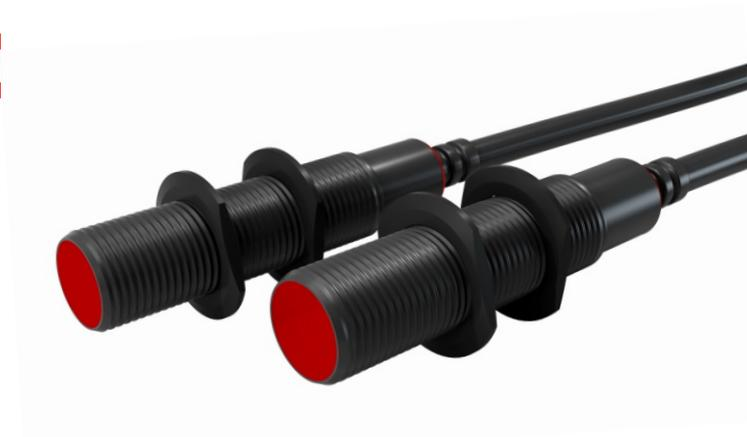
**Оптический датчик серии «SOR»** — устройство для обнаружения непрозрачных предметов. Используется в автоматических технологических системах в качестве бесконтактного выключателя с дальностью действия до 6000 мм. Предназначен для работы во взрывобезопасной среде, не содержащей агрессивных газов и паров в концентрациях, приводящих к коррозии металлов.
