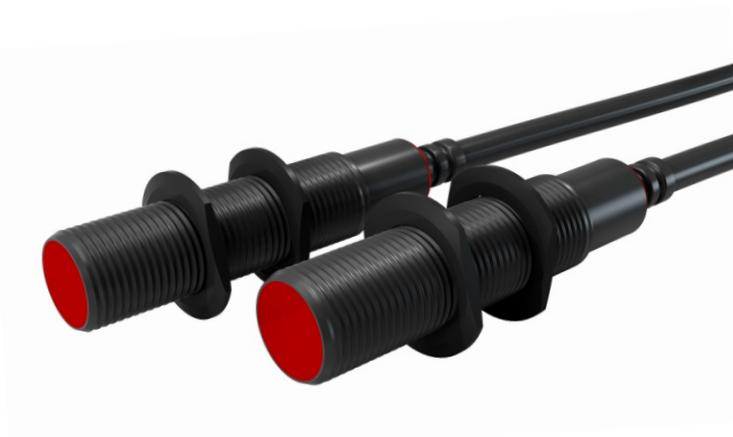
**Оптический датчик серии «SOD»** — это электронное устройство, которое обнаруживает контролируемый объект, отражающий оптическое излучение, и имеет полупроводниковый коммутационный элемент управления исполнительным устройством. Является элементом автоматизированных систем управления технологическими процессами.
